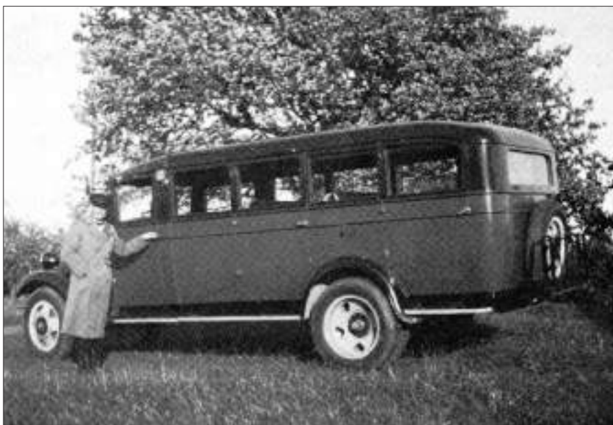
Till bortamatcherna anlätades Harry Larsson, Storegården Rackaby, som innehade en lastbil som lätt omgjordes till buss. Under veckan var lastbilsflaket på och vid veckosluten hissades det av och busskarossen på.
